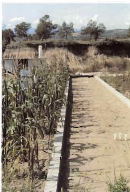
C ouple de parcelles de tepetate cultivé, à nu (type Wischmeier) et sous maïs, pour mesure de l'érosion, Tlalpan, Tlaxcala, Mexique.
