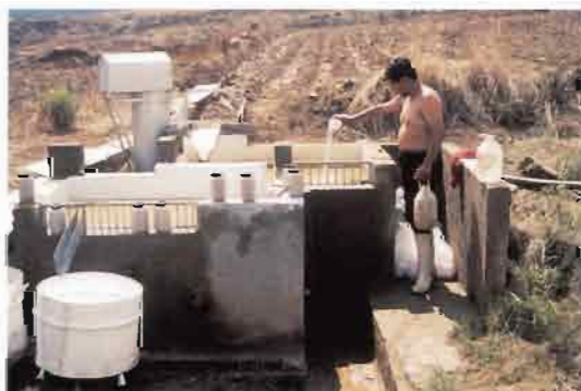
M esure du ruissellement et de l'érosion sur une terrasse de tepetate cultivé, près de Texcoco, vallée de Mexico.
