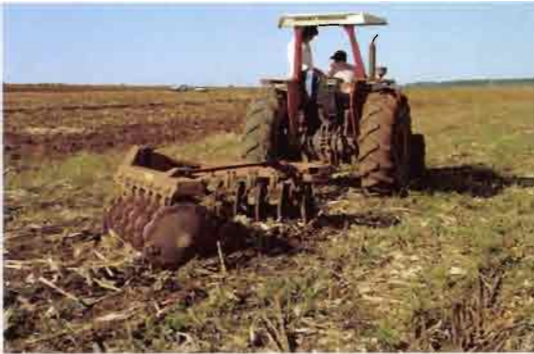
O util pour la préparation du sol : pulvérisateur à disque lourd, châssis autoporteur.
