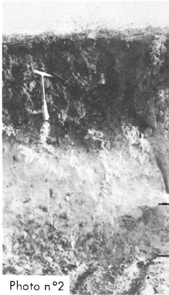
Passage progressif entre l'encroûtement tuffeux et un horizon à amas friable
