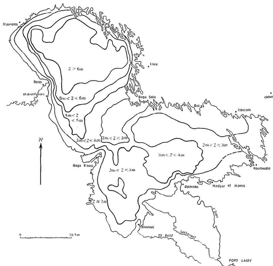
Fig. 3. — Carte bathymétrique du lac Tchad. Les profondeurs sont ramenées à la cote 282 du plan d'eau (Carmouze et Dupont, 1970).
