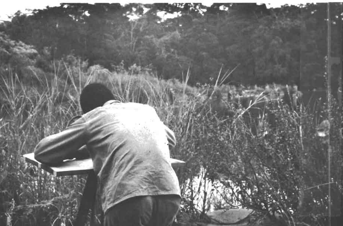
PH. 63. — Idem . Le cadastrage : le chef topographe au travail sur les bords de la Comoé. La difficulté d'implanter une station sur les rives (ici relativement facilitée par la présence d'un rapide, à droite). (Cliché Cl. Surroca)
