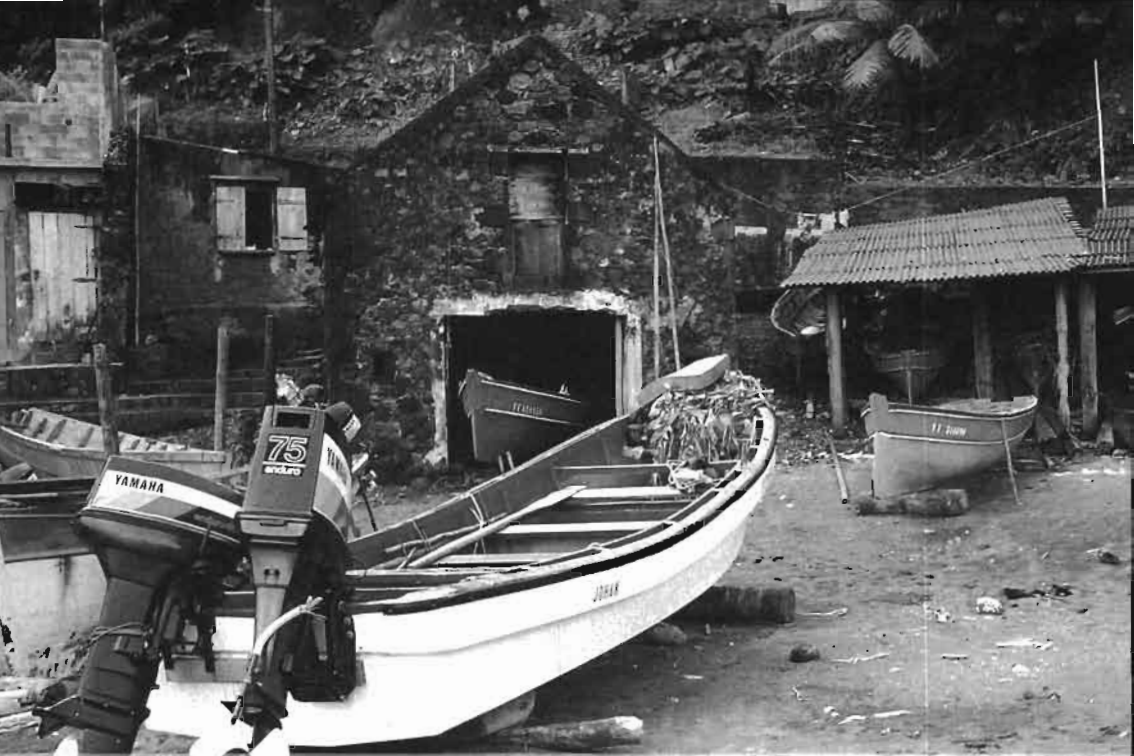
▼ « Yole plastique » à terre, montrant ses deux moteurs hors-bord.
