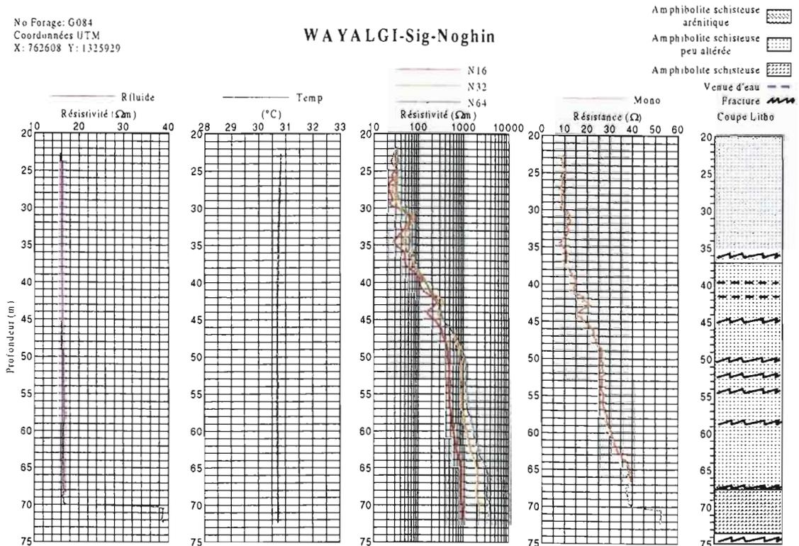
Figure 1 : Diagraphies expéditives classiques avant hydrofracturation.
