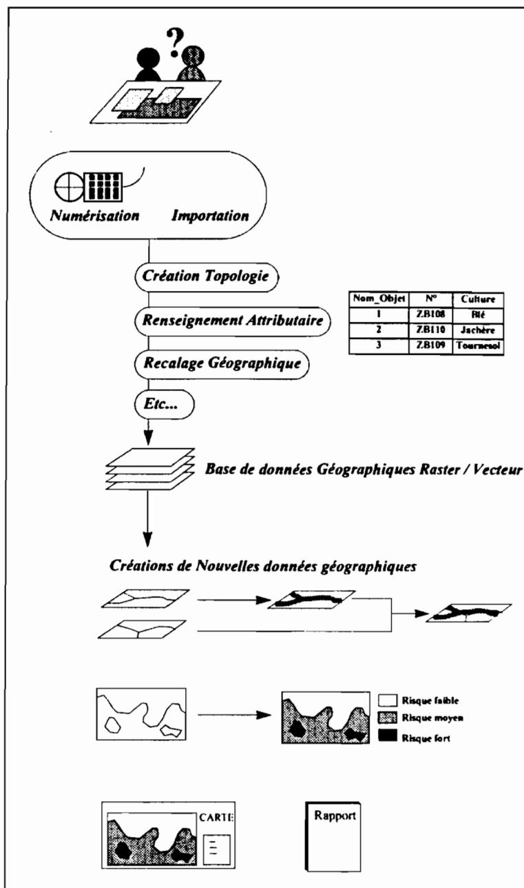
Figure n°7 : les différentes phases d'un projet SIG
