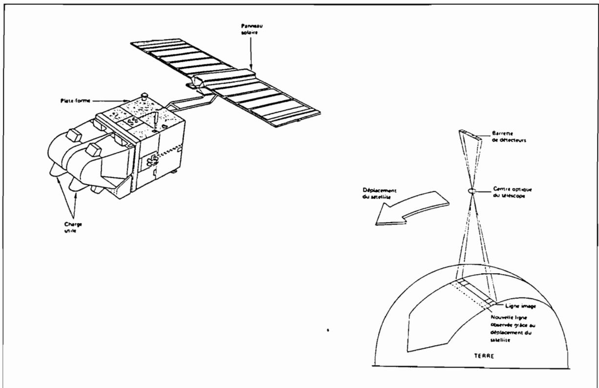
Figure n°4 : vue d'ensemble du satellite SPOT et mode d'enregistrement d'une image
