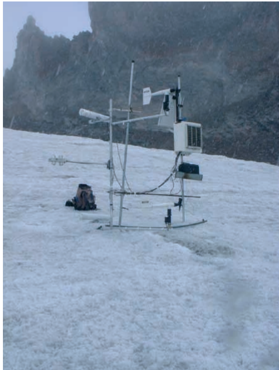
Photo 1 Station météorologique automatique Campbell à 4 900 m (Antisana) Estación meteorológica automática Campbell a 4.900 m.s.n.m. (Antisana)
