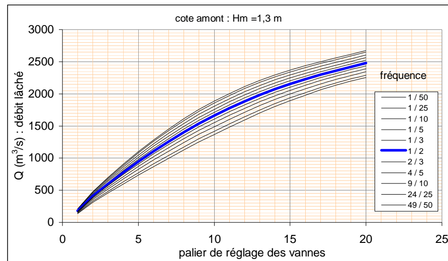
Figure 7A : Débit Q lâché du barrage pour différentes fréquences de dépassement et pour un niveau amont Hm égal à 100, 110, 120 ou 130 cm, en fonction du palier P de réglage des sept vannes.
