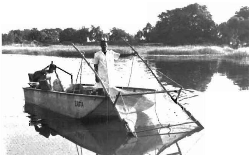
*Photo 4 - Chalut avant électrifié expérimenté au Tchad.*
