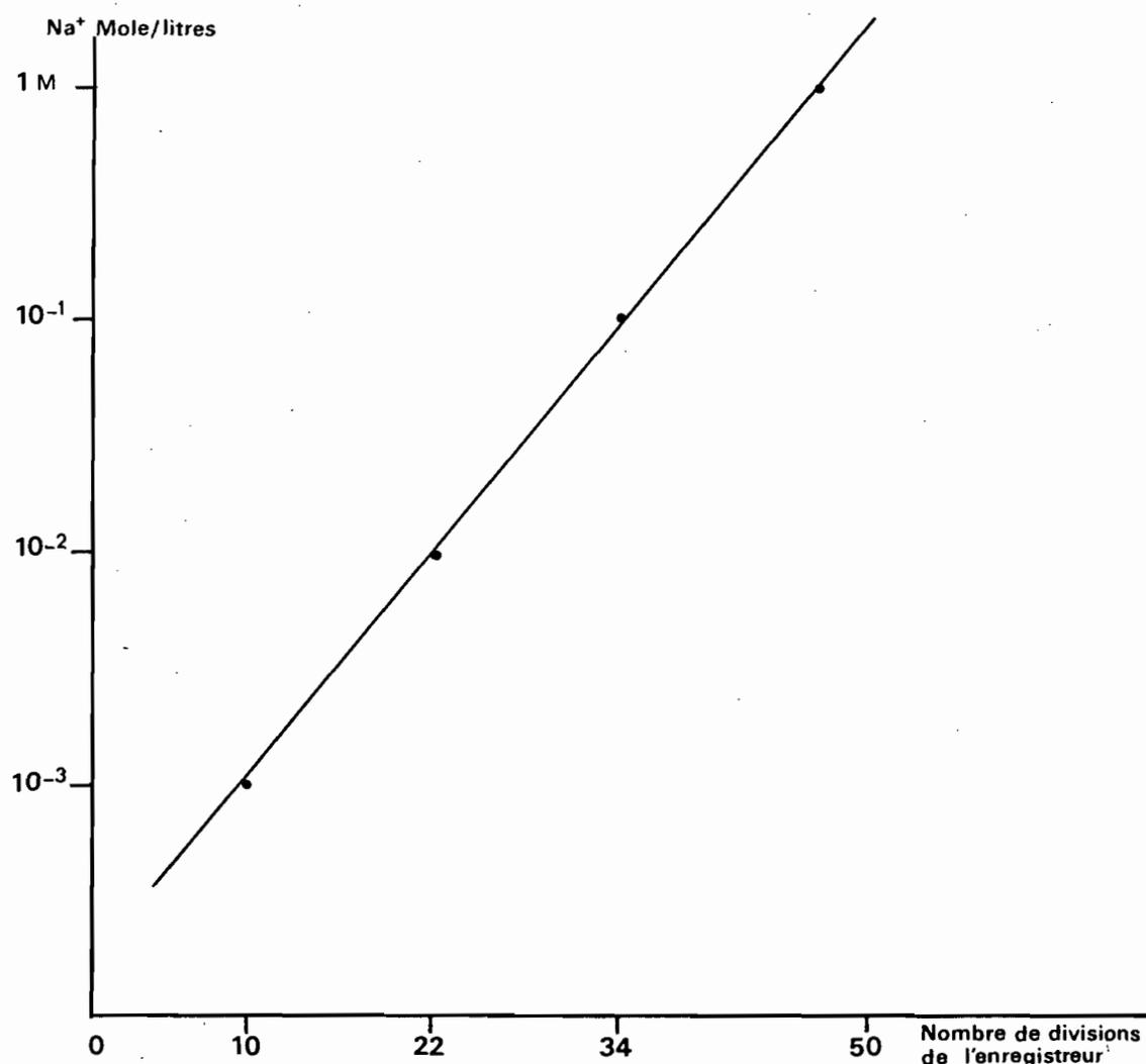
Fig. 2 - Courbe d'étalonnage de l'électrode Sodium
