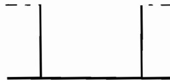
Ouverture dans la façade sans arrière plan (AP) : vide de profondeur infinie. C'est donc un chemin hydraulique de type bloc avec  $h_{AP} = 0$  et  $R=1$ .
