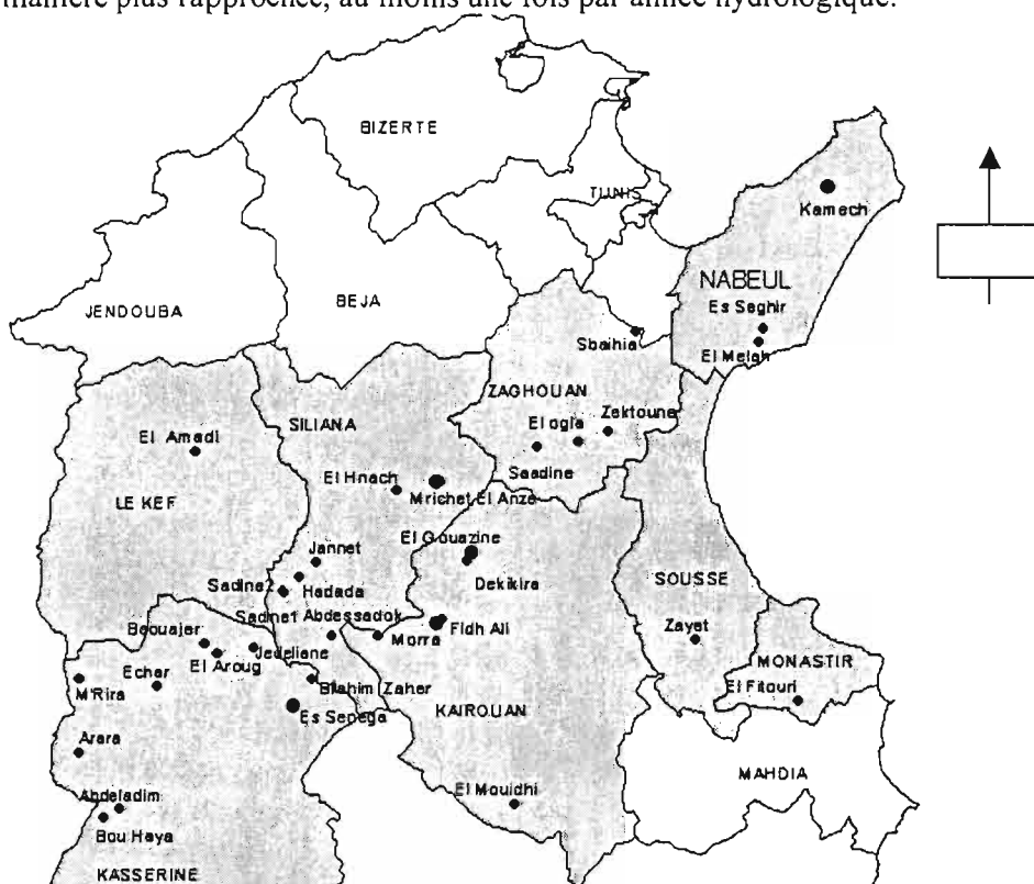
Carte 1 : Le réseau d'observations des petits barrages tunisiens (rouge : bathymétrie tous les ans) Des prélèvements ponctuels des eaux déversées permettent de connaître la matière solide exportée.
