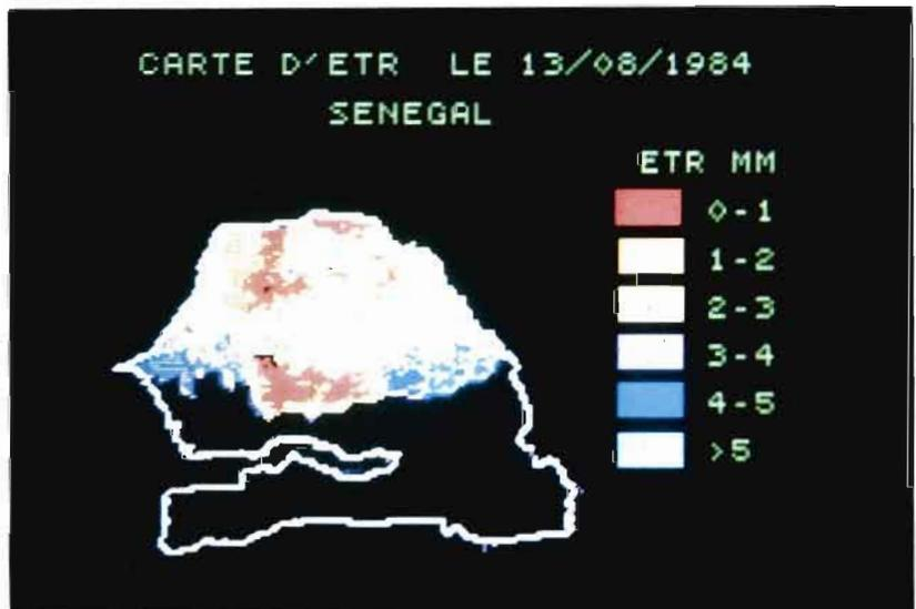
FIGURE. 5 - Cartographie d'ETR obtenue à partir des données Meteosat et de la relation simplifiée  $ETR - R_n = 1.0 - 0.25 (T_s - T_a)$  pour deux journées particulières (a. 17-07-1984, b. 13-08-1988).
