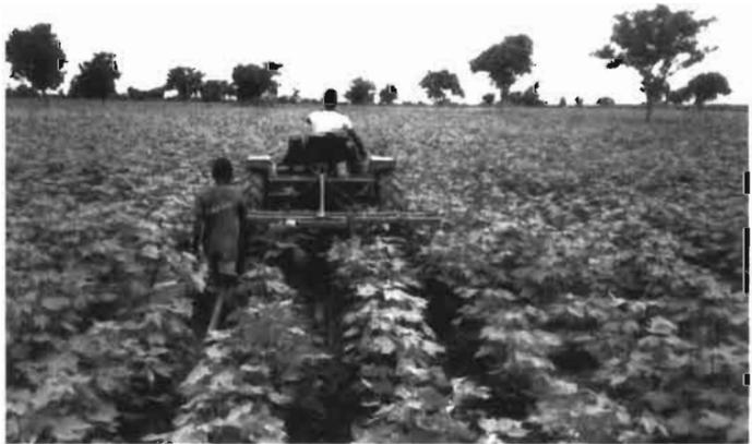
11. Le tracteur « Boyer » de 30 chevaux, monté dans les ateliers d'assemblage de la Sofitex de Bobo-Dioulasso. Une prise de force à l'arrière lui permet d'entraîner un moulin à céréales ou une égreneuse à maïs. Une charge de 500 kg peut être transportée sur le petit plateau à l'avant du tracteur.
