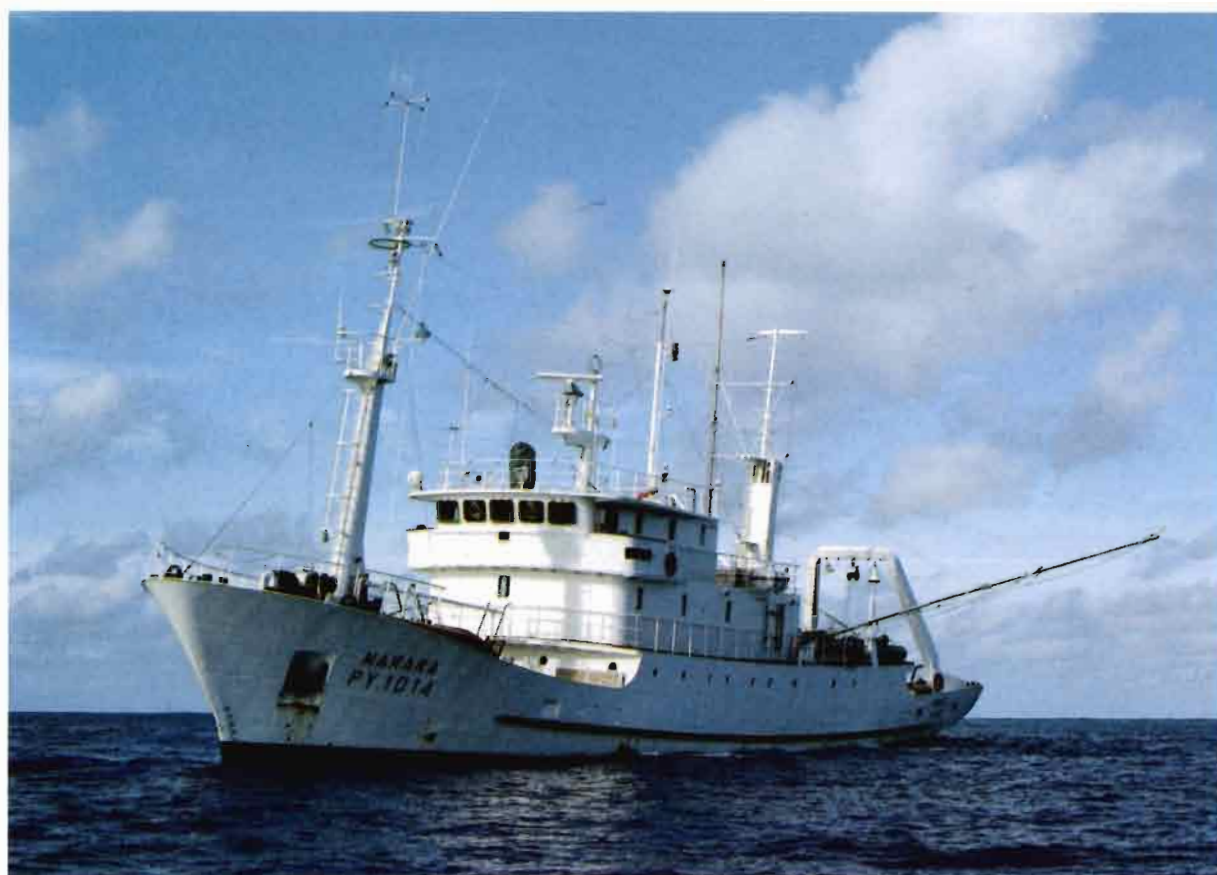
Fig. 1 - Le bâtiment de contrôle biologique «Marara» (43 m, 1200 cv, 400 tonnes).
