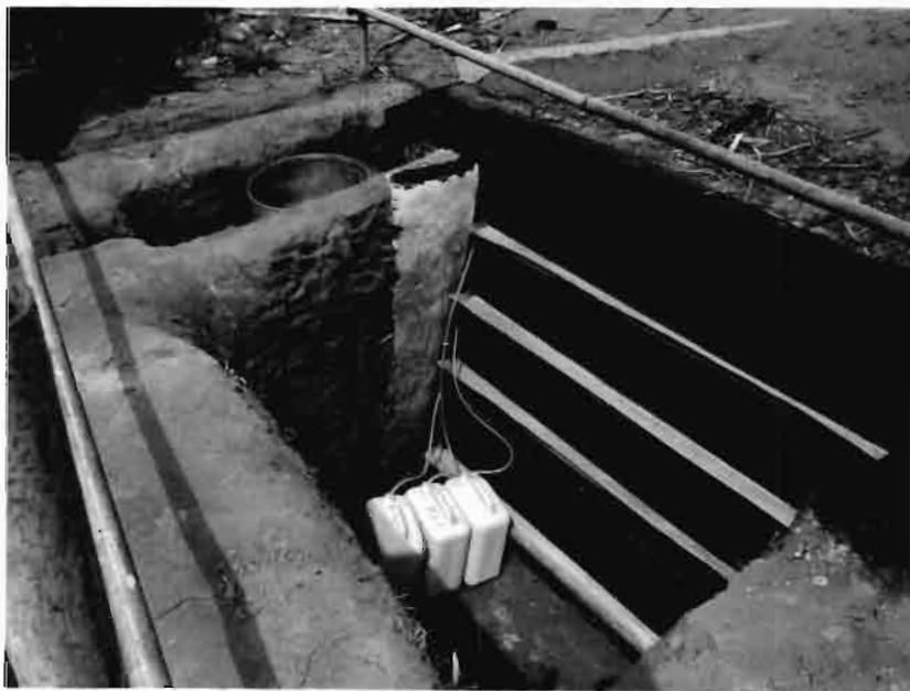
Détail de la case d'érosion et de lessivage oblique : les gouttières "g" reliées aux jerrycans par des tuyaux en plastique ; le canal "c" du ruissellement débouche directement dans un fût de 200 litres ; le toit a été enlevé pour la photo. (Photo DUVAL)
