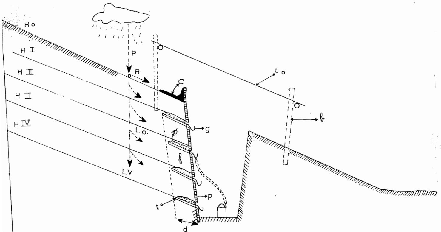
Figure n° 2 Schéma des mouvements de l'eau de gravité et d'une "case de lessivage oblique".
