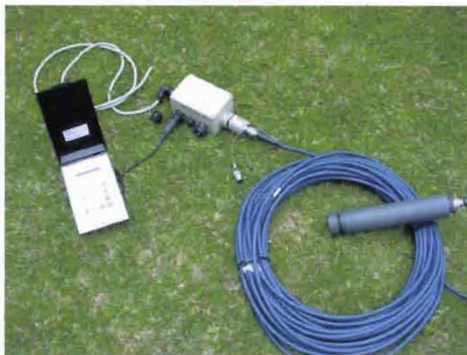
▪ Foto 6.2. El limnigrafo LIMNI 92 de SERPE-IESM (ex CHLOE) (B.Pouyaud)
