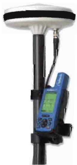
• Foto 5.4. El GPS PromarkII® utilizado con su antena (Foto Thales navigation®).
