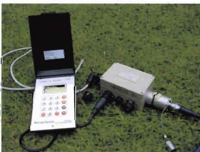
▪ Foto 6.4 Registrador limnigrafico LIMNI 92 y terminal de inicialización y lectura TD91 (B.Pouyaud)
