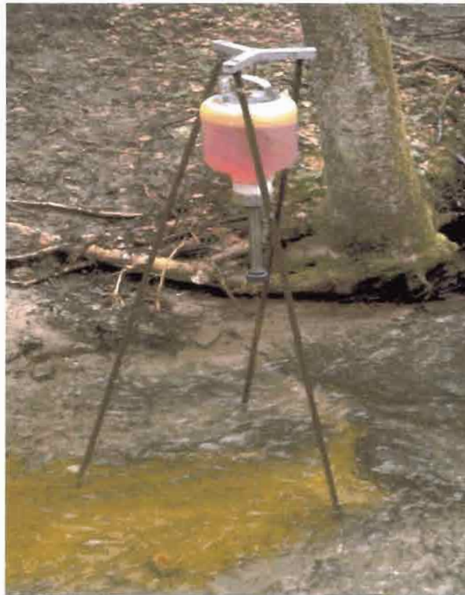
• Foto 6.13. Aforo por dilución a caudal constante (J. Musy)
