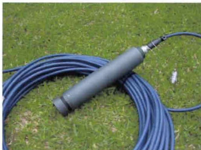
▪ Foto 6.3. La sonda piezo-capacitiva CCI V1.0 y su cable de conexión con el sensor de presión atmosférica (B.Pouyaud).
