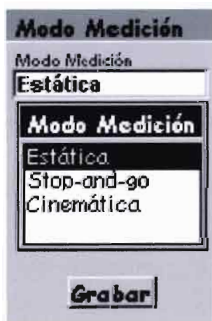
• Foto 5.6. Pantalla Modo Medición del ProMark2. Foto Thales navigation®
