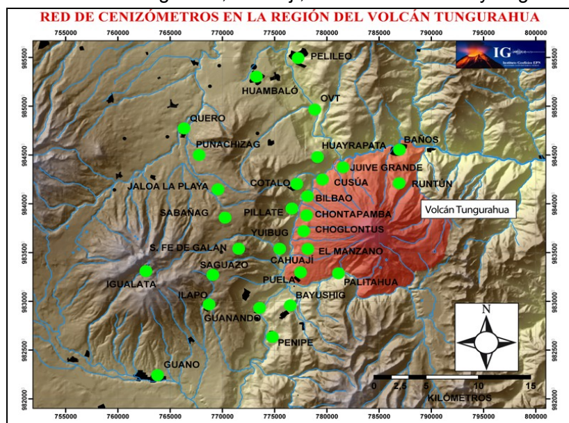
Figura 1. Red de colectores de ceniza (cenizómetros) en el volcán Tungurahua (Modificado de Bustillos, 2010)
