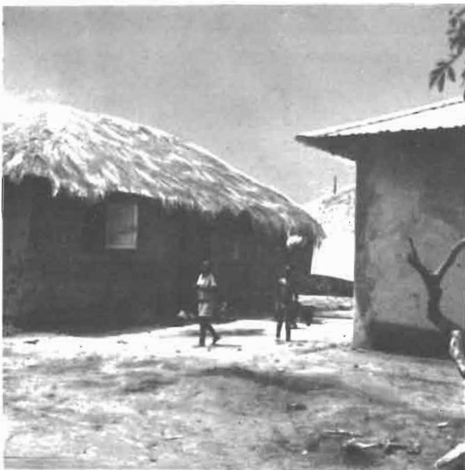
Une maison proche de la case traditionnelle : petites dimensions, couverture végétale. Les murs de briques séchées recouvertes d'un enduit de glaise, les portes et volets de bois montrent des essais de modernisation.
