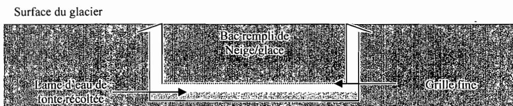
Figure 2.6 : Schéma d'une boîte à fusion.
