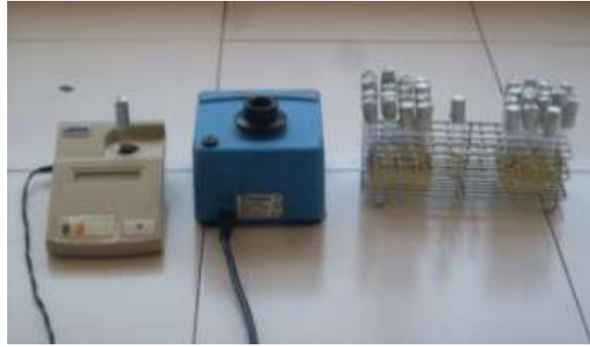
Figure 20: Appareillage de suivi de la cinétique de croissance bactérienne
