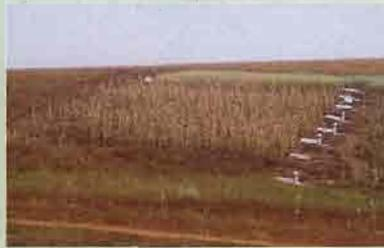
Parcelas de erosión (350 m<sup>2</sup>) con sus dispositivos de captación de agua y sedimentos (foto C. Prat)
