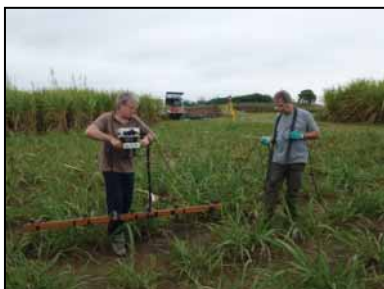
Mesures de résistivité électrique des sols
