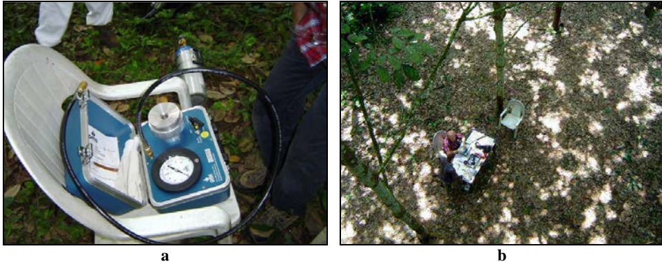
Photo 5ab. Mesure du potentiel foliaire ( \Psi_{\text{feuilles}} , en bars) avec une chambre à pression PMS®. Measurement of the leaf water potential with a PMS® pressure chamber
