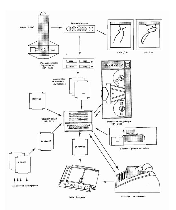
Figure 2 - Réalisation du C . A . D .
