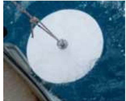
*Figure 4 : Disque de Secchi*
