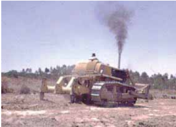
Photos 4a et 4b. Défonçage au bulldozer muni de 3 dents du tepetate , S.M. Tlaixpán, Mexique (Prat).
