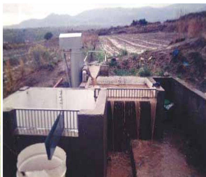
Photos 3a. Parcelles d'érosion (1 000 m 2 et 100 m 2 ) sur cangahua, Equateur (de Noni) 3b. Parcelle d'érosion avec partiteurs sous la pluie, S.M.Tlaixpán, Mexique (Prat, 1993).
