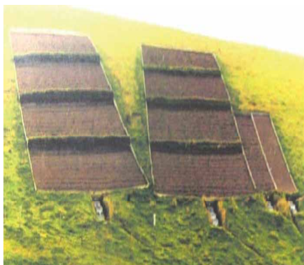
Photos 3a. Parcelles d'érosion (1 000 m 2 et 100 m 2 ) sur cangahua, Equateur (de Noni) 3b. Parcelle d'érosion avec partiteurs sous la pluie, S.M.Tlaixpán, Mexique (Prat, 1993).
