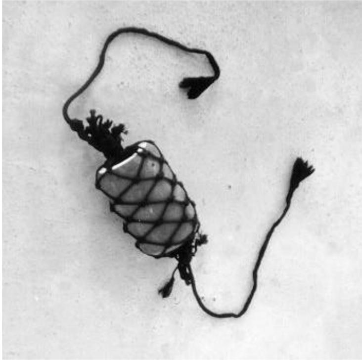
**Foto 1.-** Sensor de profundidad preparado para su sujeción al arte de cerco.
