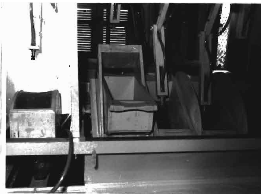
Figure 6 : Tamis pour la sépa- ration sol-racines. Entonnoir de récu- pération.
