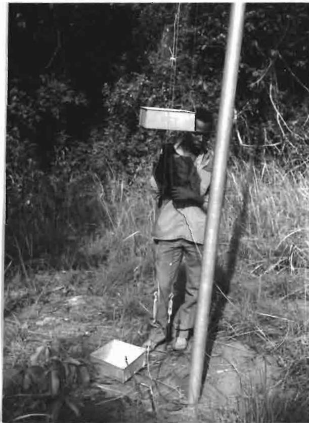
Figure 2 : Descente du train de bac (détails). Noter plus particulièrement les fils de stabilisation du train de bac, et le dispositif utilisé pour l'accrochage de ces derniers.
