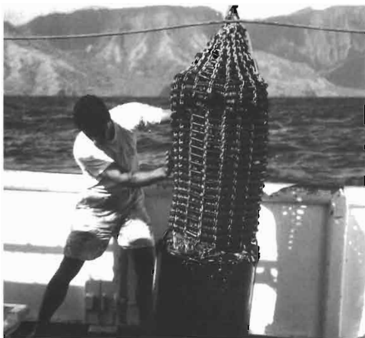
FIG. 5. — La drague à roches (DR) est vidée sur le pont au large de Nuku Hiva (photo P. LABOUE).
