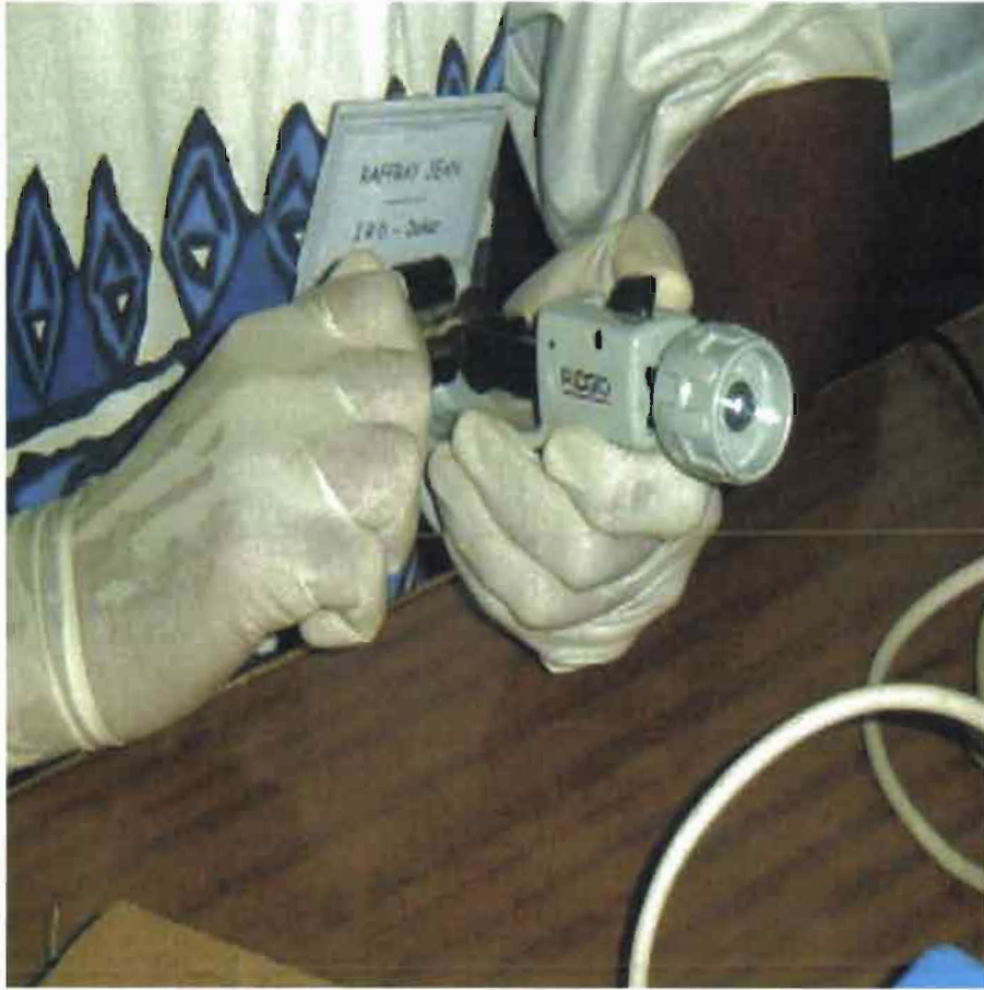
Photo 13 - Récupération des informations enregistrées dans une marque archive : Ouverture de la marque archive par coupure de l'enveloppe plastique externe.
