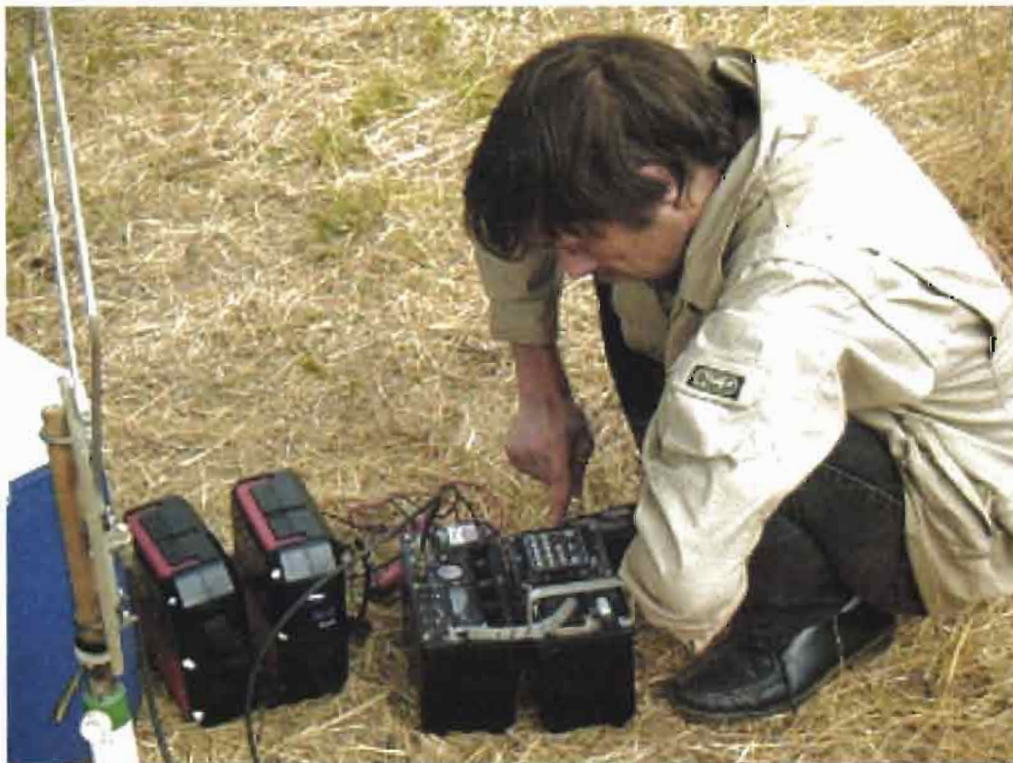
Photo 10 - Réglage d'une station automatique de biotélémétrie pour enregistrement en continu des activités des poissons relâchés dans la mare de Sélinguéni. La station se compose d'un ordinateur (à droite), d'un récepteur (au centre), d'une batterie (à gauche) et d'une antenne boucle sur pied (à l'extrême gauche).
