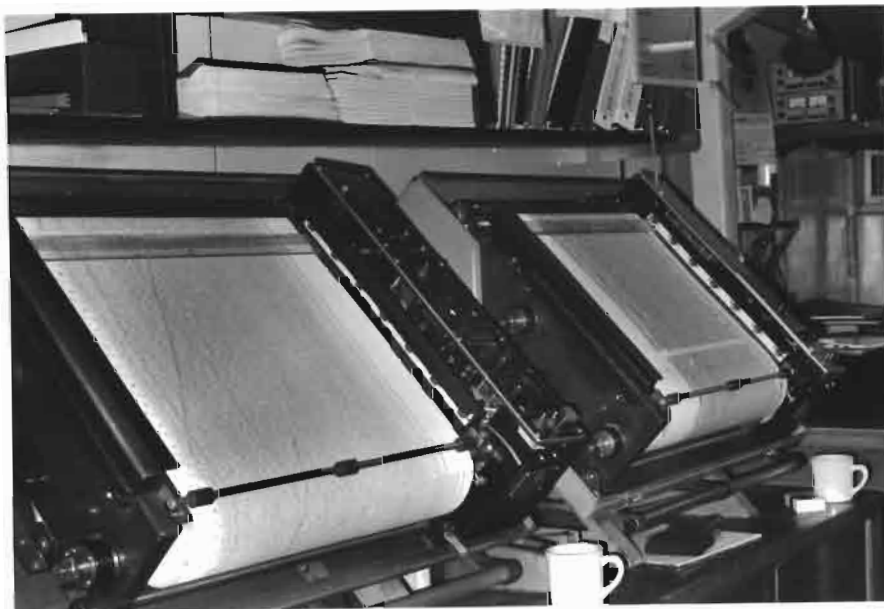
Enregistreur de type Raytheon À gauche : - coupe monotrace déconvoluée - magnétisme gravimétrie À droite : - coupe 24 traces stackée
