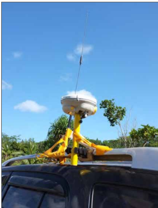
Figure C8 – Unité mobile pour les levés GPS-RTK sur le littoral de Wallis, en septembre 2011, à Wallis (photo Jo Bind, NIWA)
