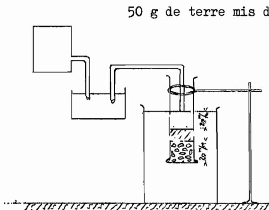
50 g de terre mis dans un tube au dessus d'une toile filtrante de 0,5 mm sont soumis à percolation par l'eau sous charge constante de 20 mm. Les résultats sont exprimés en cm/heure. Les expériences ont montré que le test de la stabilité était plus représentatif pour les terres argileuses tandis que celui de perméabilité était plus adapté aux terres légères.
