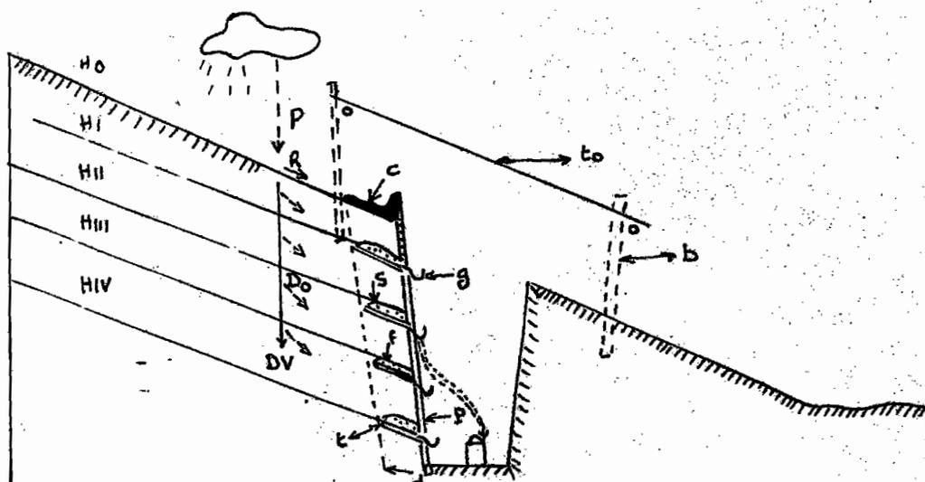
Schéma des mouvements de l'eau de gravité et d'une case de lessivage oblique.
