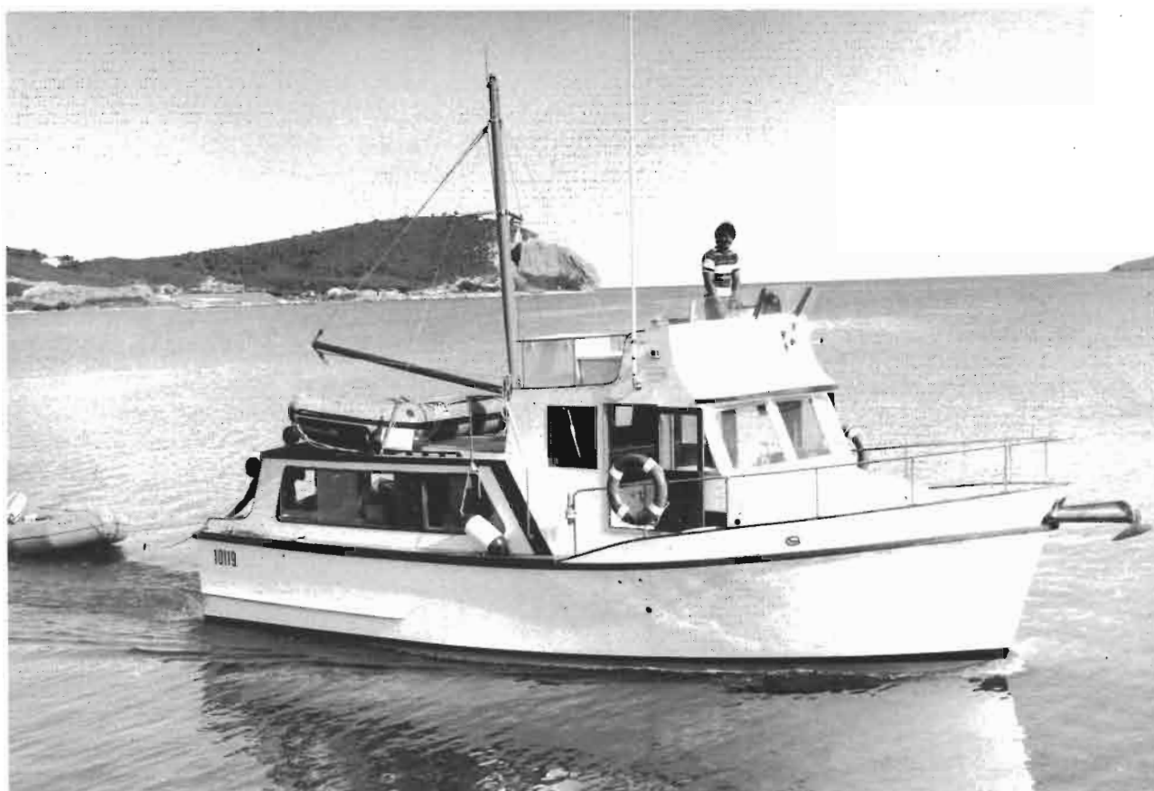
La vedette océanographique Dawa (10 mètres, 25 tonneaux) a été spécialement acquise pour ce programme. Elle possède une large autonomie, des engins de plongée et des moyens de congélation permettant la conservation des espèces récoltées.
