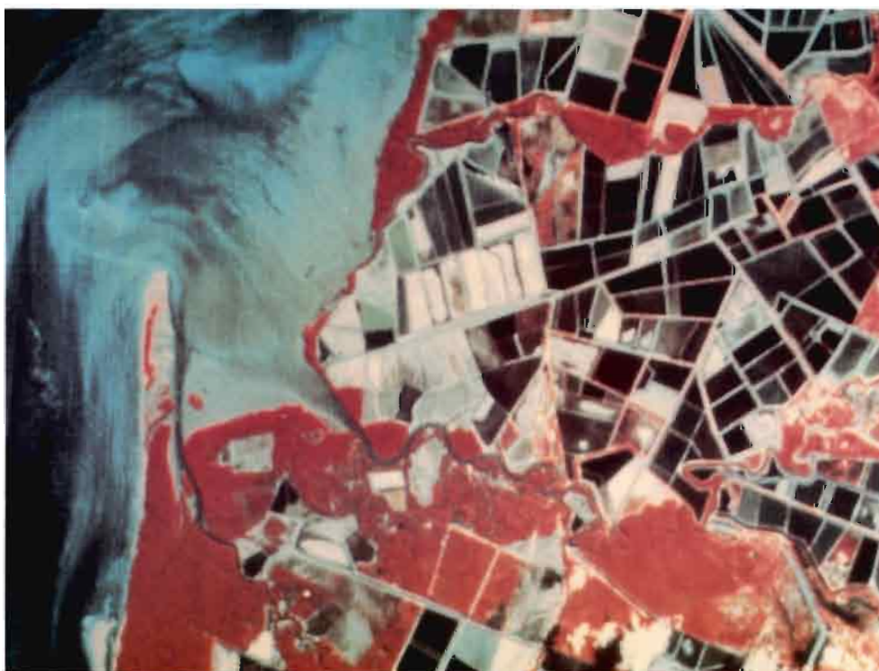
N17B : Equateur, Golfe de Guayaquil, image SPOT mode XS c CNES 1986/dist SPOT IMAGE. Exemple de destruction de la mangrove (en rouge) sous l'effet de la construction de bassins. Noter les bassins en eau (couleur foncée) et les bassins à sec (couleur claire).
