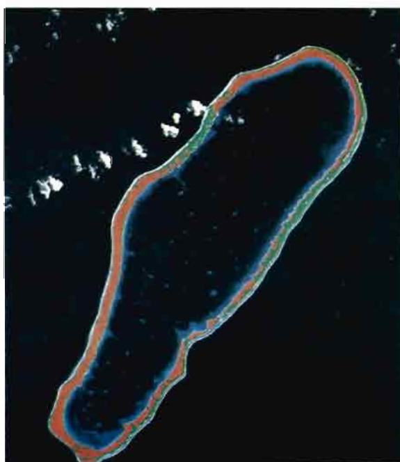
P3D : Définition de deux masques issus du seuillage passe bande sur la teinte (rouge) et passe bas sur la saturation (vert) dont l'union définit les terres émergées.
