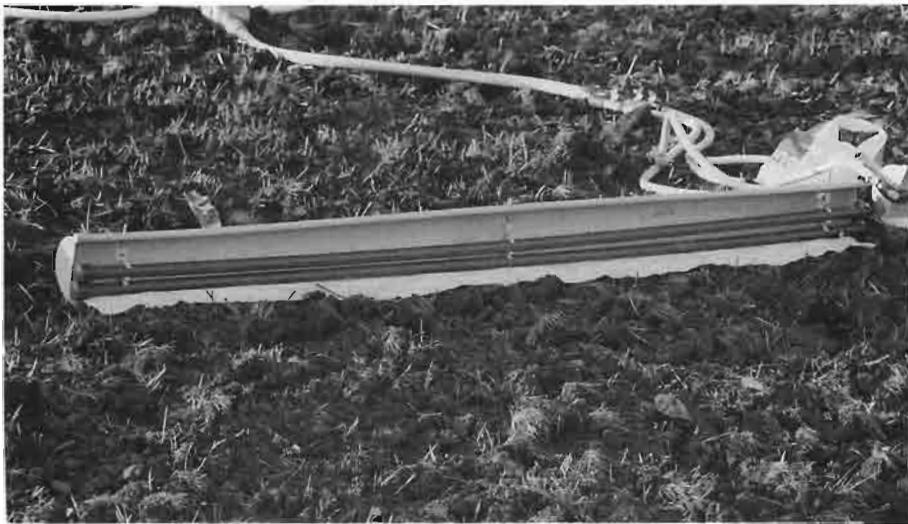
*Ce stimulateur de ruissellement, très simple à réaliser et à transporter, permet d'injecter une lame d'eau sur le sol et d'apprécier le comportement de ce dernier sous l'effet de l'énergie du ruissellement, sur une longueur de versant d'une dizaine de mètres.*
