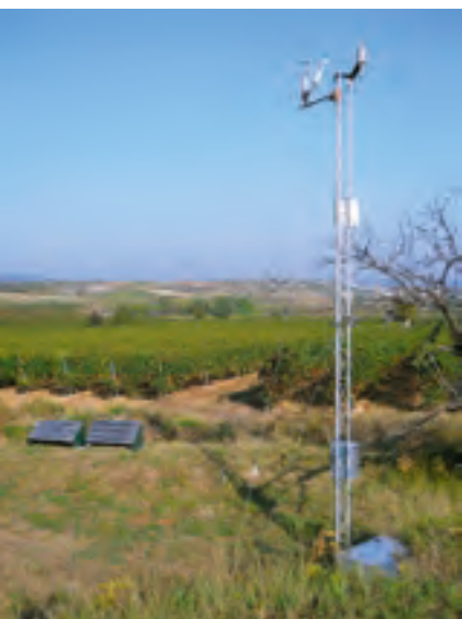
▲ Dispositif de mesure de l'évapotranspiration sur le bassin versant de Roujan
