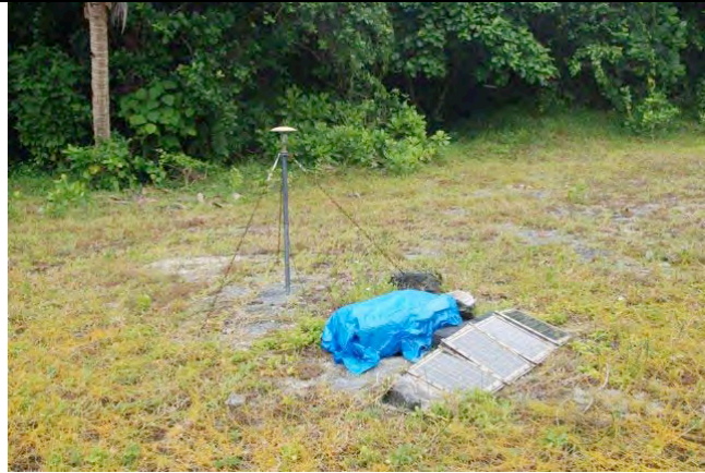
Figure 2a : GPS installé moins de 24h après le début de la crise sismique des Torres en octobre 2009 (nord du Vanuatu).
