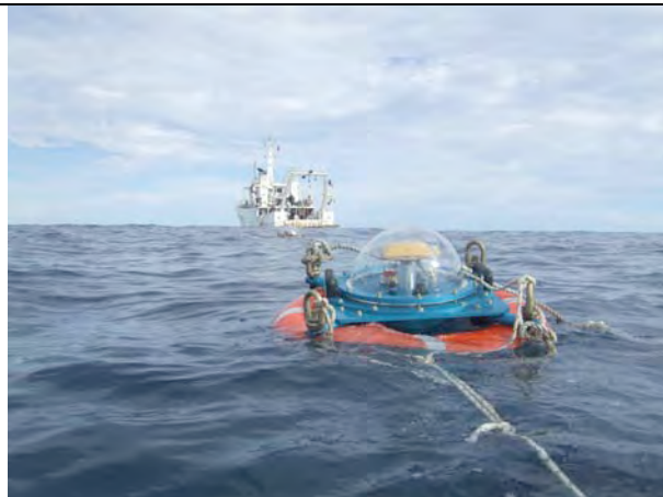
Figure 3a : Mesure de hauteur de la surface de l'eau par GPS cinématique. 2 bouées GPS et le navire N/O Alis enregistrent en même temps, à proximité du marégraphe. La différence de hauteur liée à la distance entre les différentes plateformes de mesure, non négligeable dans une zone où le gradient du géoïde est fort, sera corrigée en utilisant un modèle de géoïde.
