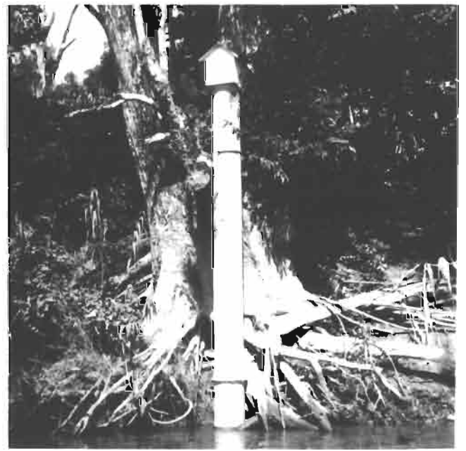
Photo n° 4 Limnigraphe Ott à flotteur fixé à un arbre (Ikopa au Bac de Fiadanana).
