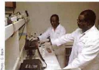
Électrophorèse sur gel d'agarose en vue d'identifier les différentes espèces de simulies adultes (technique de l'hétéroduplex).
