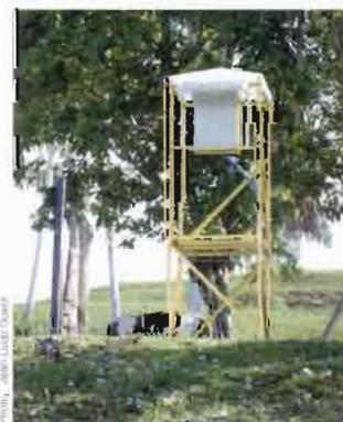
Plateforme de télétransmission satellitaire de données hydrologiques. Station de Arumá Jusante, Rio Purus, Brésil.
