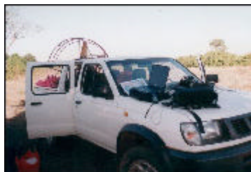
Matériel de prise de vue : appareil photo numérique, ordinateur, GPS. Sur la plateforme : hélice du paramoteur, voiles, groupe électrogène.
