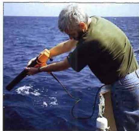
Lancement d'une sonde XBT (eXpendable BathyThermograph) destinée à mesurer la température de l'eau de mer de la surface à 700-800 m. Photo : Yves Gouriou
