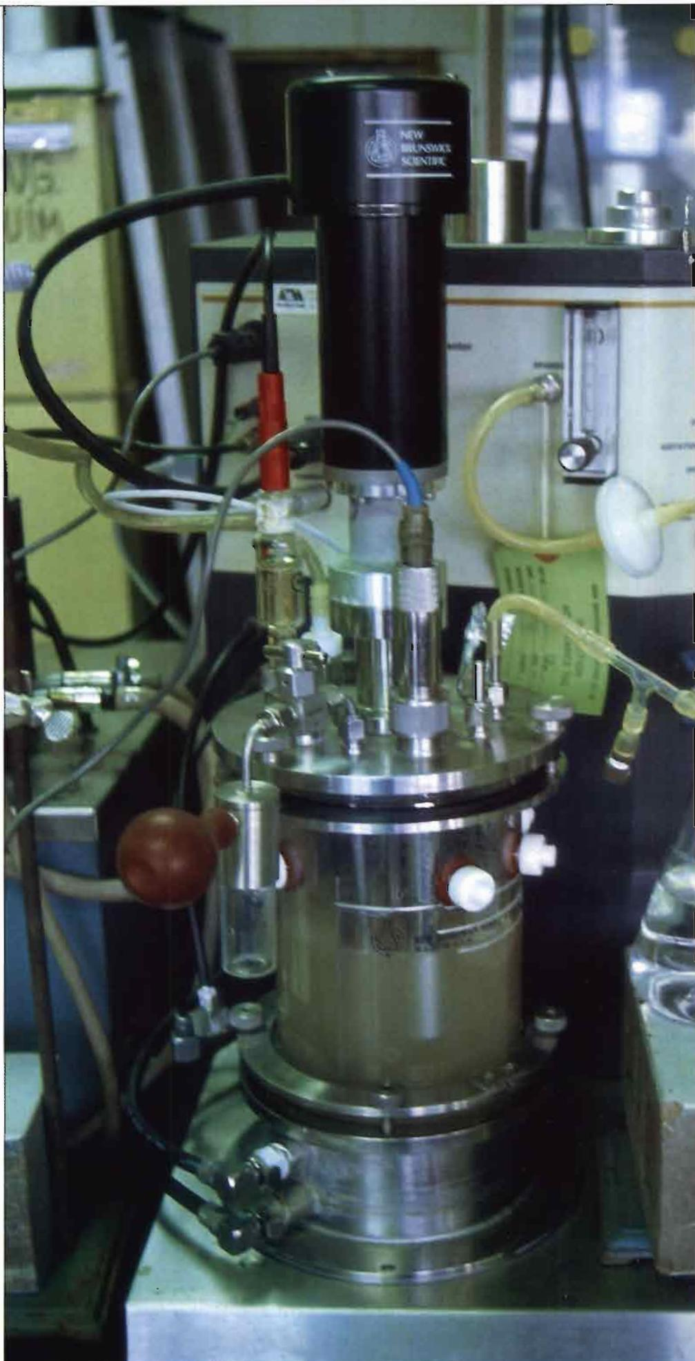
Système expérimental de bioconversion de l'éthanol en acétate d'éthyle par *Candida utilis* en milieu liquide - Photo: G. Corzo.
